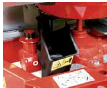
Instalace vodícího kanálu
