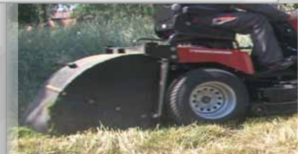
kovový kryt proti kamenům na stroji Piraña
