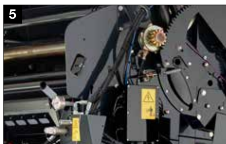
5 Proporční ventil pro ovládání utužení balíku z kabiny traktoru
