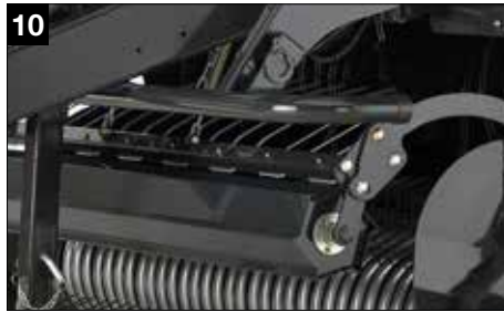
Těžký válec na plodiny s ochranou proti větru (Ø 217 mm)
