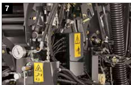
Proporční ventil pro ovládání utužení balíku z kabiny traktoru
