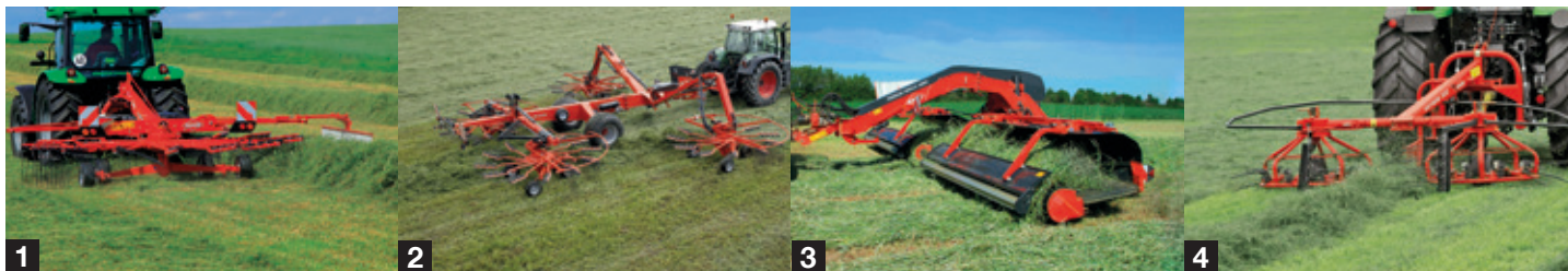
1. Nesené jednorotorové shrnovače 2. Polonesené čtyřrotorové shrnovače 3. Pasové shrnovače 4. Univerzální obrabeče a shrnovače
